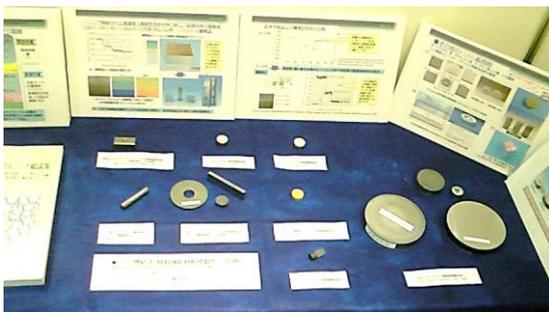
▲SPS 法により作製した傾斜機能材料(FGMs)
