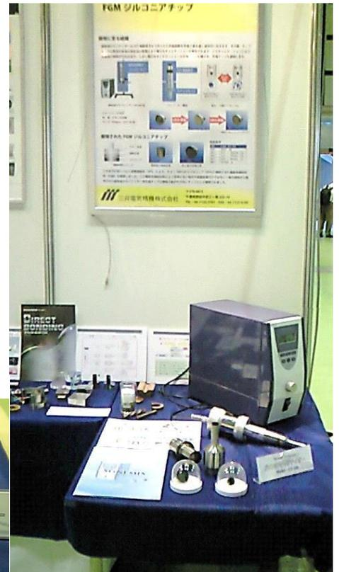
▲超音波ホモジナイザー装置 ZrO<sub>2</sub>-Ti 合金 FGM チップ付
