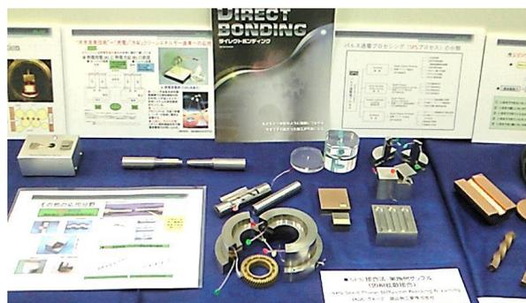
▲SPS 接合法により作製した固相拡散接合サンプル例
