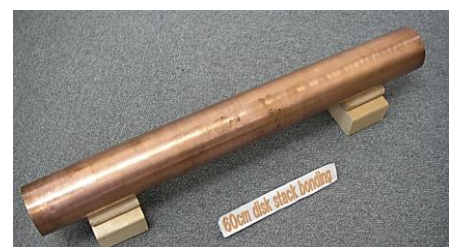
図 12 長尺純銅パイプの固相拡散接合体
