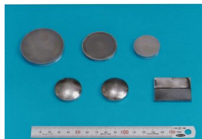
図18 表面層の中膜硬化処理例 SK 材上面に WC-Co 超硬粉末 200~800μm 直接焼結接合サンプル
