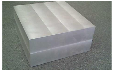
図 10 大形アルミブロックの固相拡散接合体
