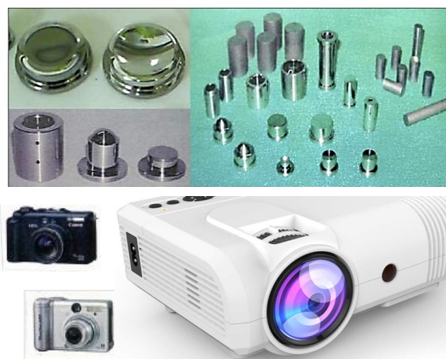
図2 非球面ガラスレンズ金型への実用化例
